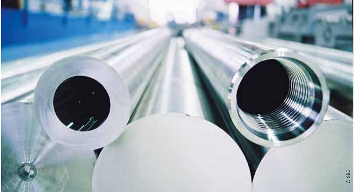
Schoeller-Bleckmann: Collars als „Hightech-Gehäuse“ für Messgeräte, Sensoren, Antennen und Generatoren.
