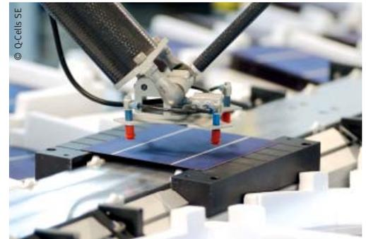
Q-Cells Produktion: Sortierung der Zellen.
